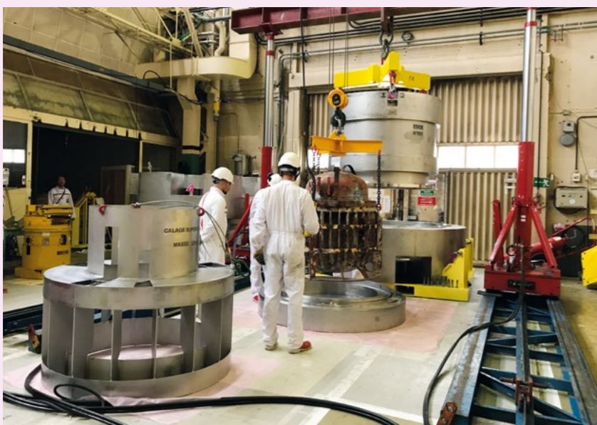
Le générateur isotopique Marguerite 20 en cours de chargement dans son emballage de transport baptisée MANON.
