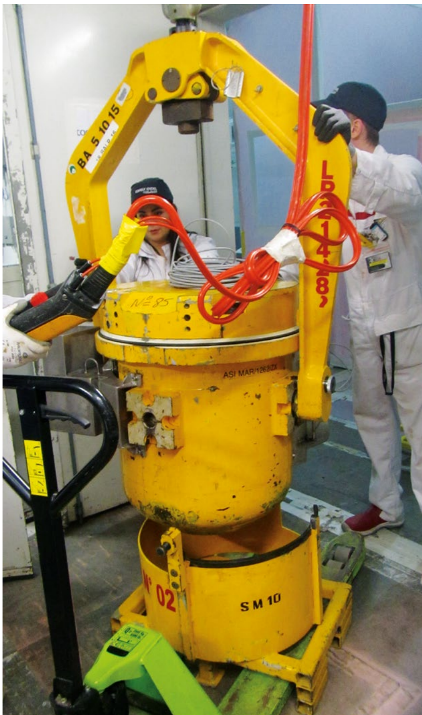
Un Padirac permet de transporter des déchets solides
