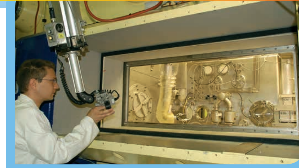
Cellule blindée et télémanipulateur
